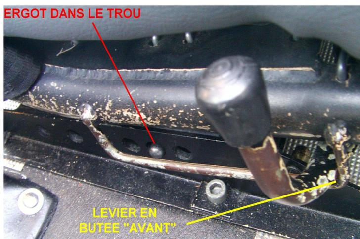
**Le verrouillage du siège du DR400 a déjà fait l'objet d'un article dans le magazine Info-Pilote N°38 de Mai 2009 qui apporte la preuve qu'un déplacement intempestif du siège peut entraîner des difficultés au roulage, voire être la cause d'accidents graves.**
