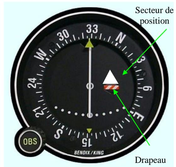
L'AXE sélectionné est une droite passant par la balise. Son orientation en référence au Nord magnétique est lue sur la rose au droit des index et s'exprime selon deux valeurs d'angle opposées de  $180^\circ$  désignées respectivement **Radial ou QDR** et **Bearing ou QDM**.
