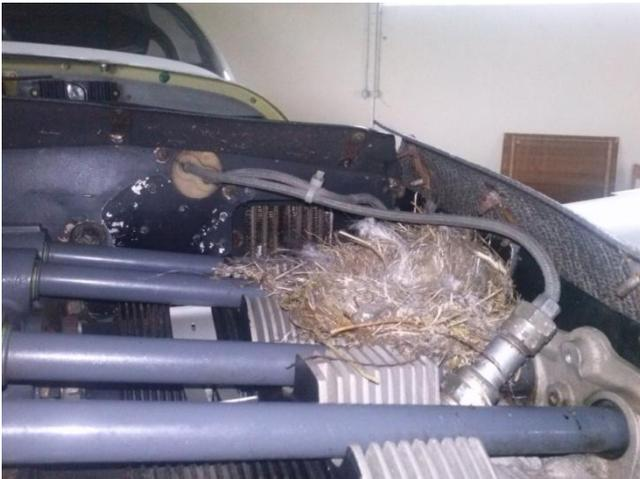
Le risque d'incendie est grand : ce n'est pas du tout certain que de tels corps étrangers soient désagrégés par l'écoulement d'air, d'où la nécessité de vérifier attentivement l'item suivant de la visite prévol (cf. C/L détaillée DR400) :
