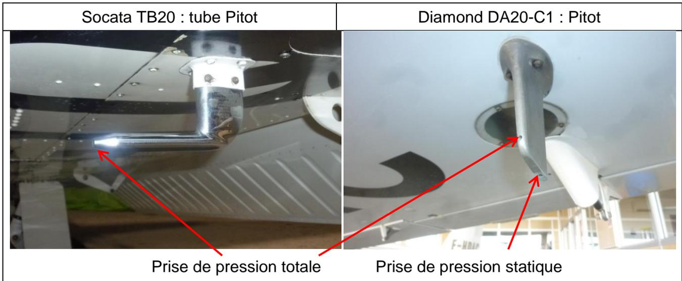
La prise « nominale » de pression statique s'effectue généralement via deux orifices placés de part et d'autre de la partie médiane du fuselage [désignés « prises statiques » ou « statiques »] avec une surface d'ouverture parallèle à l'écoulement de l'air.
