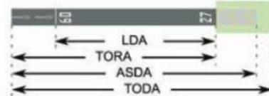
e) Piste dotée d'un décalé, d'un prolongement dégagé et d'un prolongement d'arrêt
