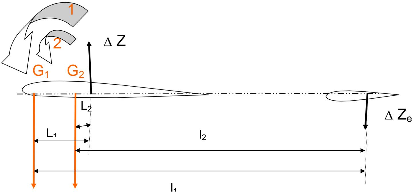
Si le centrage est très avant ( $G_1$ ), le moment de  $\Delta Z$  est important et le moment de tangage créé par l'empennage peut ne pas suffire : l'avion est limité en manœuvrabilité.
