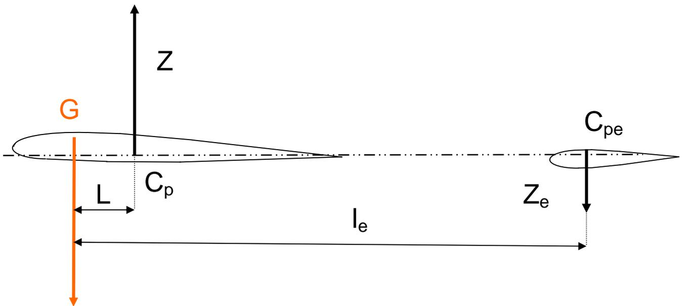
La portance de l'aile crée un moment piqueur autour de G : la déportance d'empennage contre ce moment et permet l'équilibre statique (en l'absence de variations de l'incidence ou du vent relatif).
