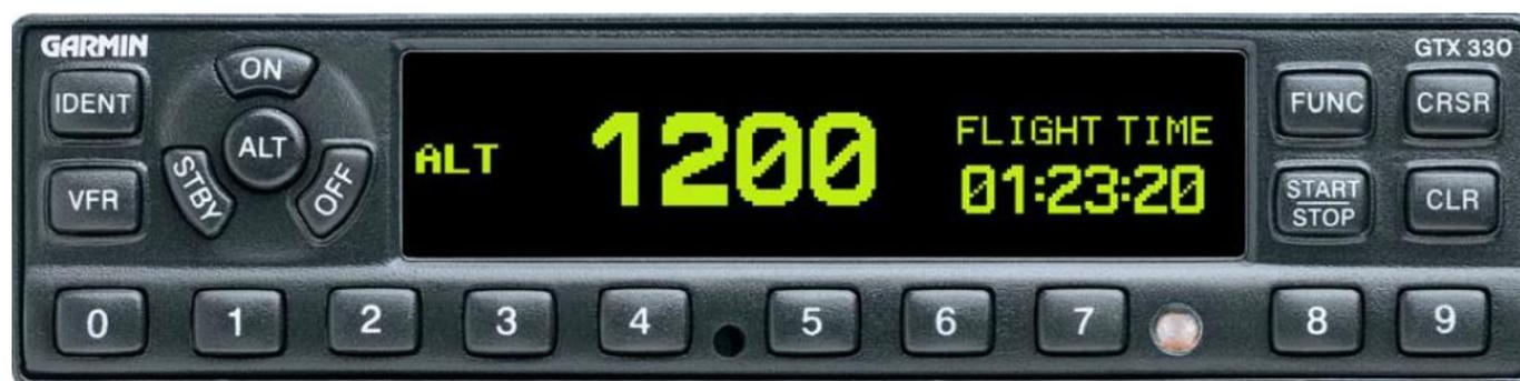
Sur ce transpondeur la commande manuelle du fonctionnement en GND est un appui long sur la touche STBY.
