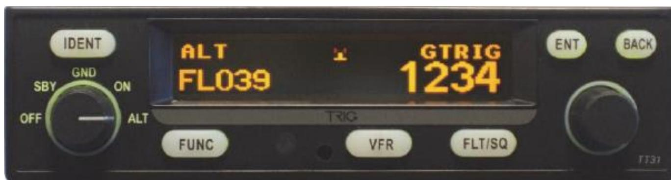
Sur ce transpondeur la commande manuelle du fonctionnement en GND est visible sur le sélecteur rotatif de gauche.
