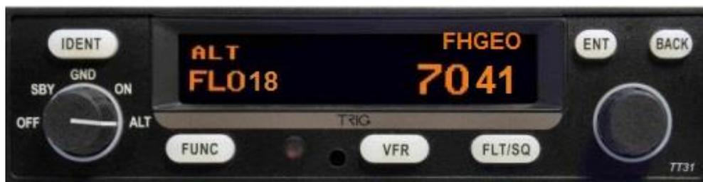
Lorsqu'un biais important est constaté sur la valeur FL, il provient généralement d'un dysfonctionnement du boîtier électronique externe qui mesure la pression statique et la traduit en altitude (Cf. DR 4).
